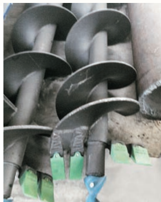
Punte per terreni normali a partire da diametro 350 mm compreso Points for normal soils for diameter 350 mm and up
