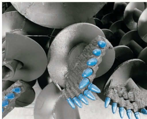
Punte per terreni sassosi, rocciosi Points for rocky, stony soils
