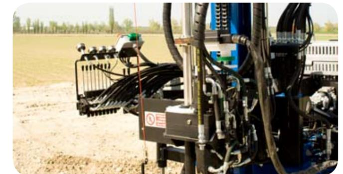
L'unico svantaggio delle sonde VIBRASOND rispetto alle sonde tradizionali è che questo tipo di sonda non è realizzabile in terreni di elevata durezza (ghiaiosi e rocciosi) per questi tipi di terreno Hydra costruisce una serie di macchine di perforazione in grado di realizzare perforazioni fino a 150 - 200 mt di profondità su qualsiasi tipo di terreno.
