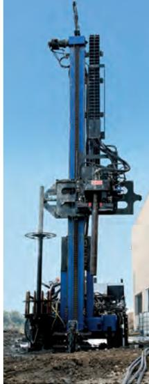
La perceuse JOY 4 peut être équipée d'un système automatique de chargement de tubes et de tiges complètement radiocommandé, tout le système permet des perforations jusqu'à des profondeurs importantes sans devoir manipuler manuellement les tiges et les tubes de perforation.
